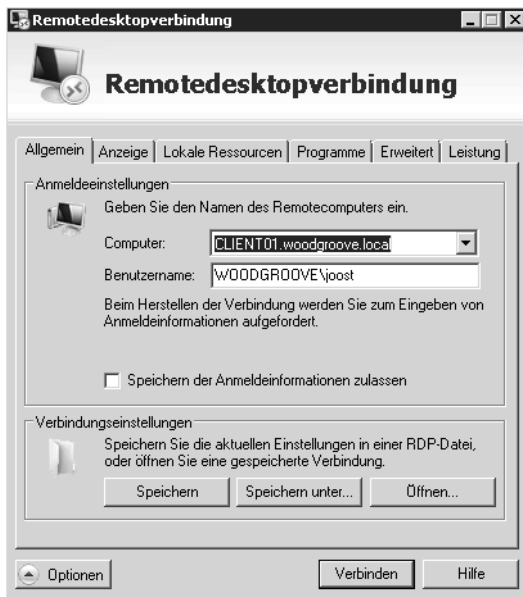
Abbildg. 5.28 Verbindungsaufbau mit einem Computer durch die Remotedesktopverbindung
