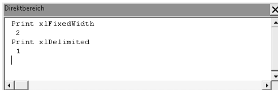
Abbildung 2-4 Im Direktfenster vom VB-Editor können Sie den eigentlichen Wert von Konstanten wie beispielsweise xlFixedWidth abfragen.
