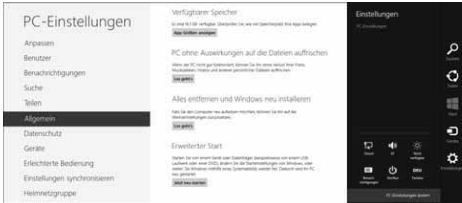
Abbildung 4.37 Zugriff auf die Systemreparaturfunktionen (Windows 8.0)
